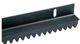
ACS9090 CRÉMAILLÈRE M6 en métal (sect. 30 x 30 mm) peinte avec CATAPHORÈSE, avec cornière 45x45 mm en barres de 2 m au m
